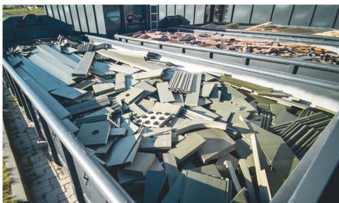
**Recycling von Windkraftflügeln:** Die Firma Novo-Tech zerkleinert ausrangierte Windradflügel in einem Rotorreißer. Daraus wird ein kreislauffähiger Holzwerkstoff hergestellt. Bild: © Novo-Tech
