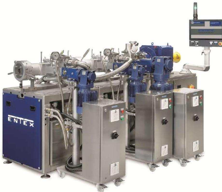
Novo-Tech setzt Entex-Extruder ein, um unter anderem die aus glasfaserverstärkten Kunststoffen bestehenden Rotorblätter von Windkraftanlagen mittels Compoundierung aufzubereiten. © Entex
