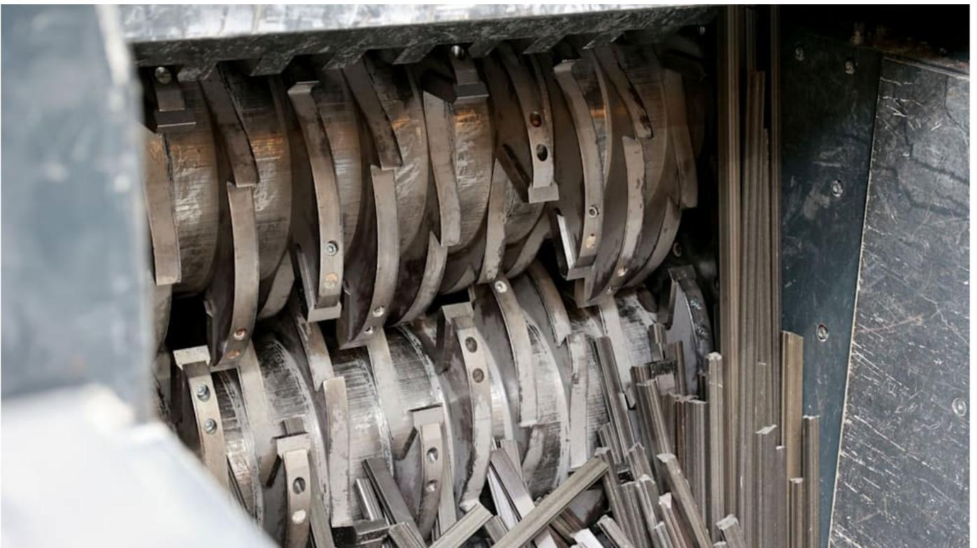
**Diese Maschine häckseln die Windradflügel klein**
