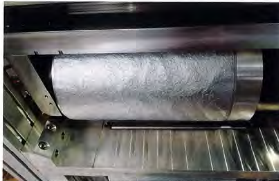
Gemeinsam mit DPS wurde ein spezieller Postprozessor entwickelt, der eine 3D-Freifformfläche über einen Zylinder wickelt. Der so modifizierte Walzenmantel dient dem Prägen von Mustern, die beliebige Oberflächenstrukturen in den Megawood-Paneeelen wiedergeben
