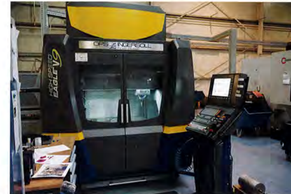
Wird mit SolidCAM programmiert: OPS-Ingersoll High Speed Eagle V9 für die 3- bis 5-Achsbearbeitung (indexiert als auch Simultan)
